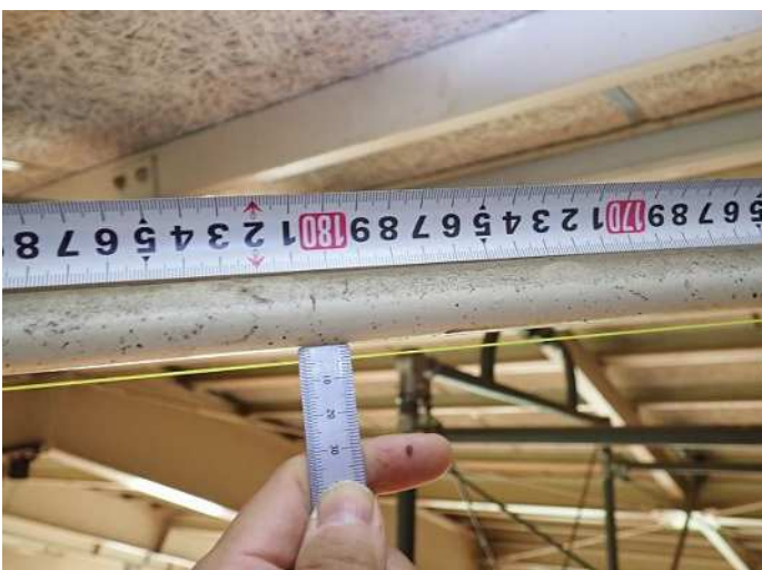
梁間方向 測定用水系設置部中央 水系との距離4mm (変形量 4mm) 写真番号 10
