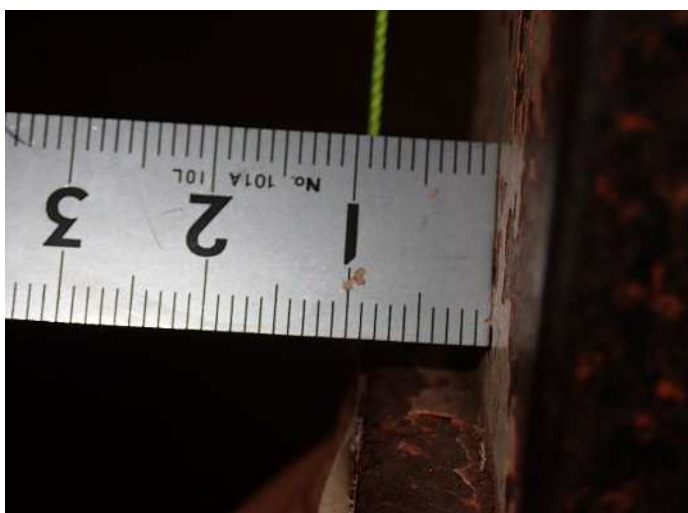
桁行方向 測定用水系設置部終点 水系との距離9mm 写真番号 3
