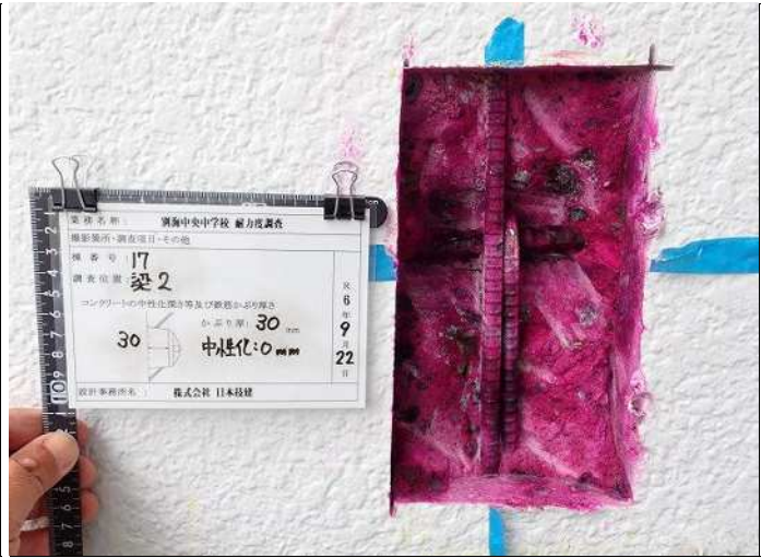
梁2 コンクリート中性化深さa 中性化深さ:0.0cm 写真番号 41
