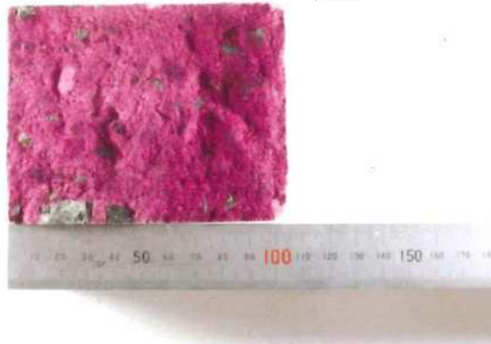
コンクリートの中性化深さ測定(フェノールフタレイン法) 別海中央中学校耐力度調査 別海中央中学校 35 壁2
