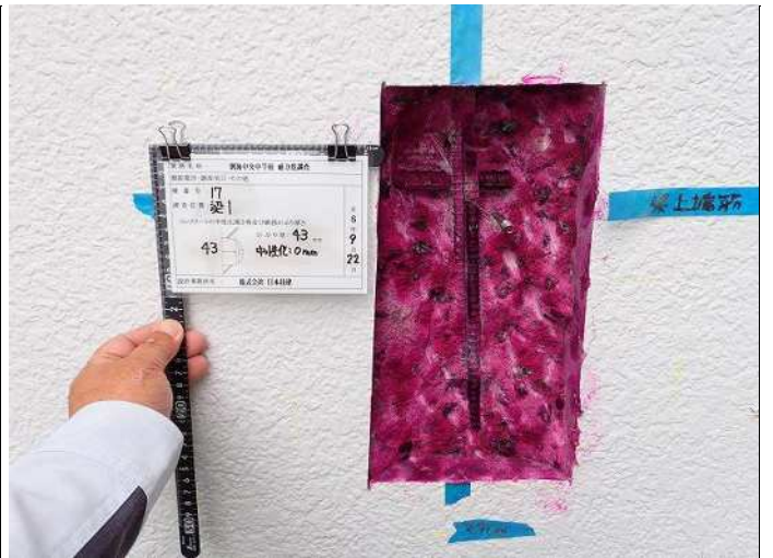
梁1 コンクリート中性化深さa 中性化深さ:0.0cm 写真番号 30
