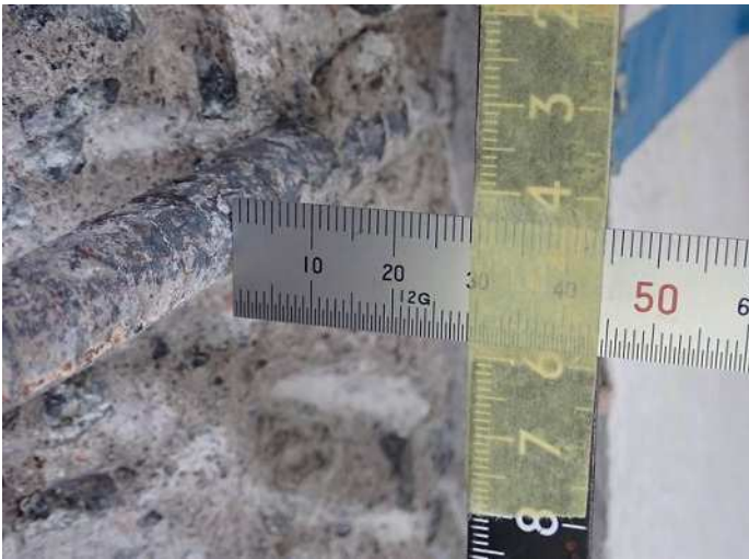
柱頭・柱1 鉄筋かぶり厚さb 写真番号6詳細 写真番号 7
