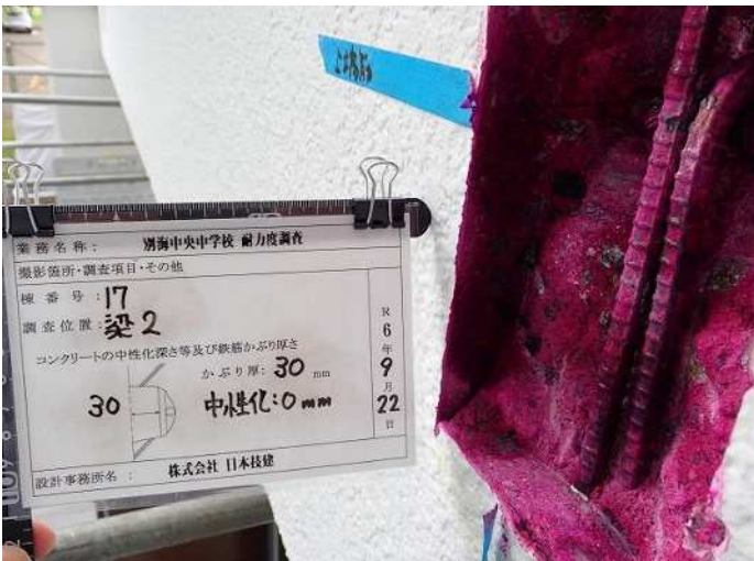
梁2 コンクリート中性化深さa 写真番号41詳細(1) 写真番号 42
