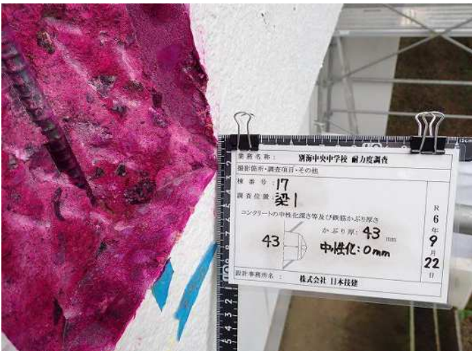
梁1 コンクリート中性化深さa 写真番号30詳細(1) 写真番号 31
