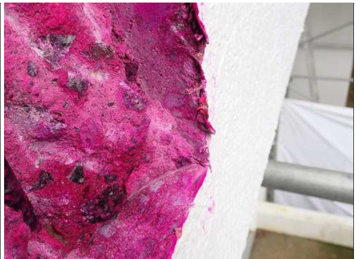
梁1 コンクリート中性化深さa 写真番号30詳細(2) 写真番号 32
