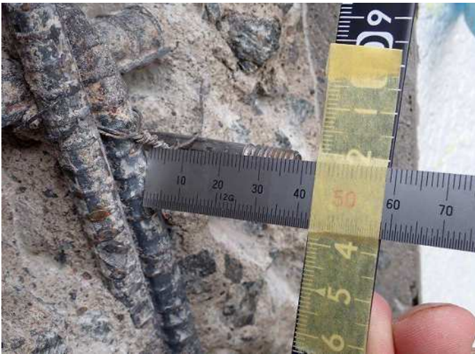
梁1 鉄筋かぶり厚さb 写真番号28詳細 写真番号 29
