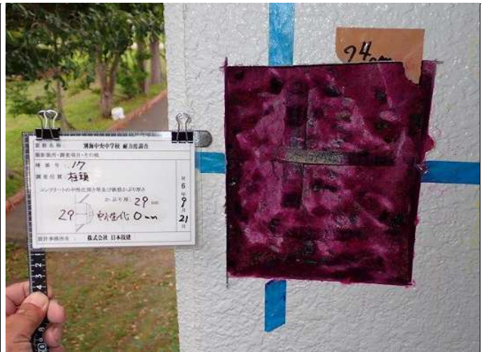
柱頭・柱1 コンクリート中性化深さa 中性化深さ:0.0cm 写真番号 8
