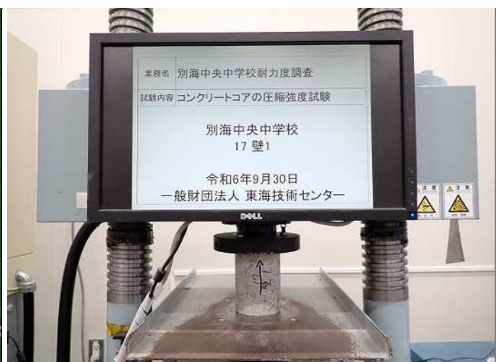
壁1 コンクリート圧縮強度k コンクリート圧縮強度試験状況 写真番号 6
