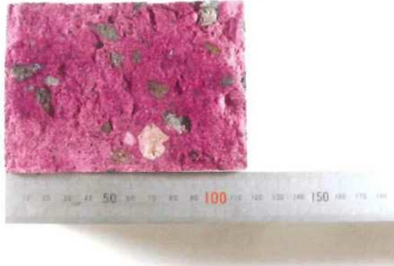
コンクリートの中性化深さ測定(フェノールフタレイン法) 別海中央中学校耐力度調査 別海中央中学校 35 壁1
