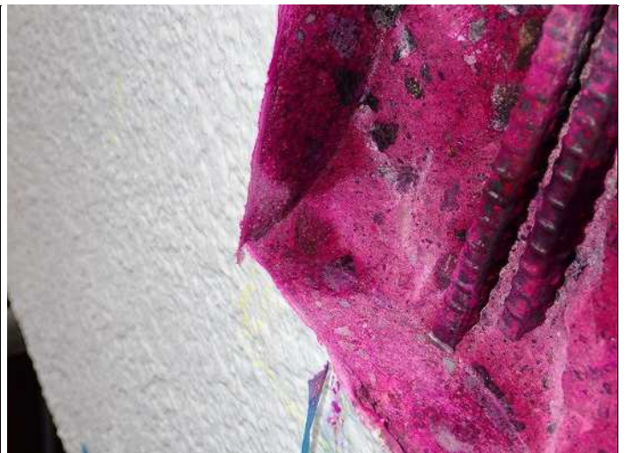
梁2 コンクリート中性化深さa 写真番号41詳細(2) 写真番号 43
