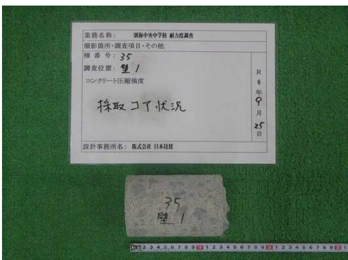
壁1 コンクリート圧縮強度k 採取コア状況 写真番号 5
