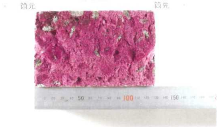
コンクリートの中性化深さ測定(フェノールフタレイン法) 別海中央中学校耐力度調査 別海中央中学校 13-2 壁1
