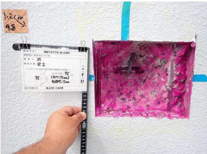
梁2 コンクリート中性化深さa 中性化深さ: 0.5cm 写真番号 44
