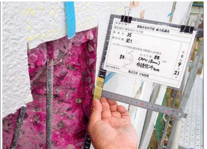
梁1 コンクリート中性化深さa 写真番号32詳細(1) 写真番号 33
