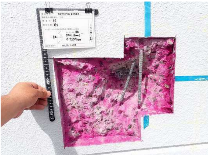
梁1 コンクリート中性化深さa 中性化深さ:0.4cm 写真番号 32
