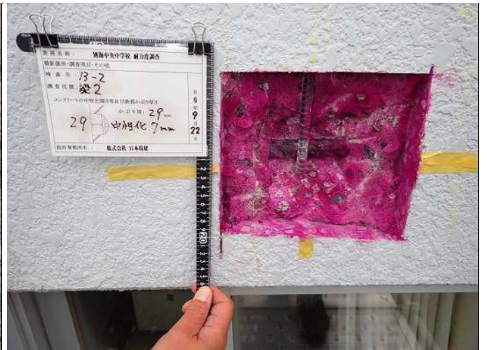
梁2 コンクリート中性化深さa 中性化深さ:0.7cm 写真番号 44
