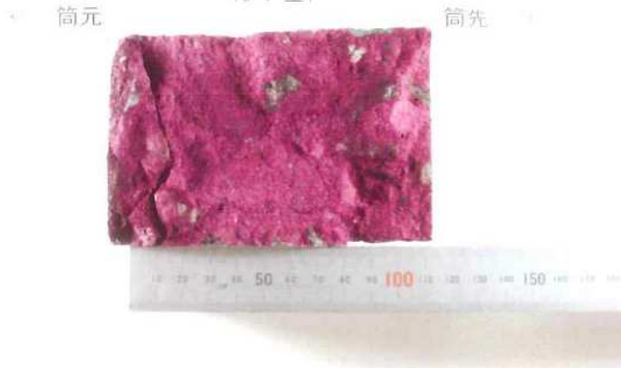
コンクリートの中性化深さ測定(フェノールフタレイン法) 別海中央中学校耐力度調査 別海中央中学校 13-1 壁1
