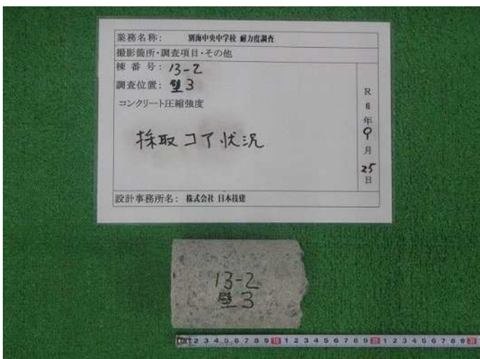
壁3 コンクリート圧縮強度k 採取コア状況 写真番号 17
