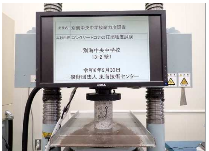
壁1 コンクリート圧縮強度k コンクリート圧縮強度試験状況 写真番号 6
