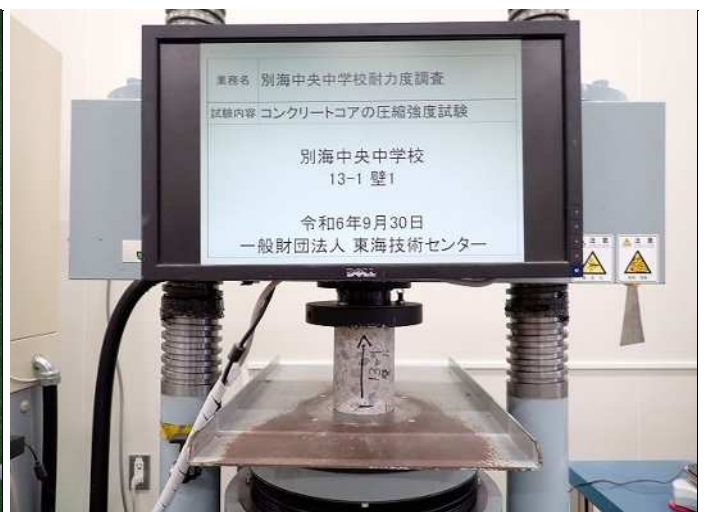
壁1 コンクリート圧縮強度k コンクリート圧縮強度試験状況 写真番号 6
