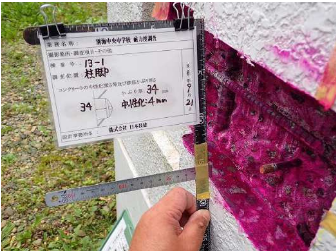
柱脚・柱2 コンクリート中性化深さa 写真番号21詳細(1) 写真番号 22
