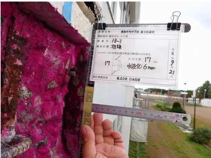
柱頭・柱1 コンクリート中性化深さa 写真番号10詳細(1) 写真番号 11
