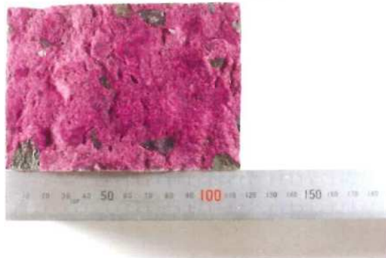
コンクリートの中性化深さ測定(フェノールフタレイン法) 別海中央中学校耐力度調査 別海中央中学校 35 壁3
