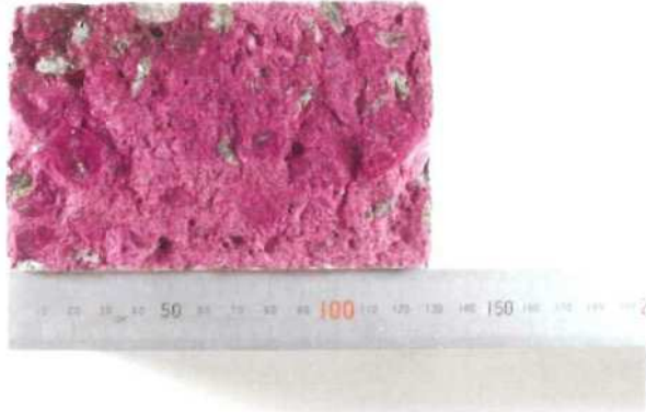
コンクリートの中性化深さ測定(フェノールフタレイン法) 別海中央中学校耐力度調査 別海中央中学校 13-2 壁1
