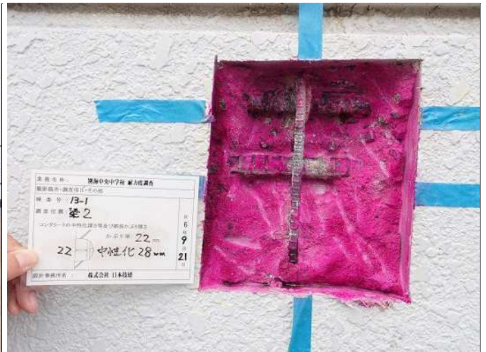
梁2 コンクリート中性化深さa 中性化深さ:2.8cm 写真番号 43
