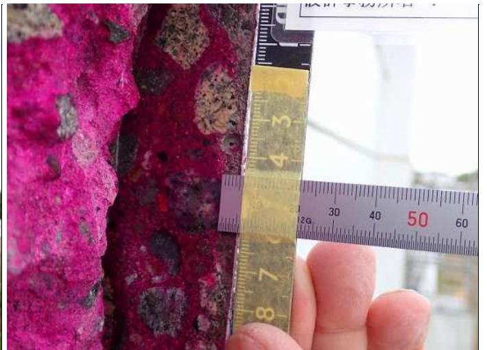
柱頭・柱1 コンクリート中性化深さa 写真番号10詳細(2) 写真番号 12
