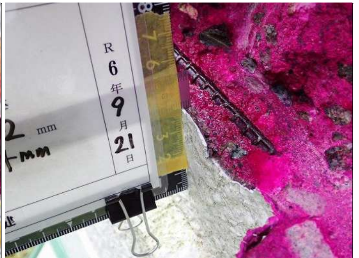
柱脚・柱2 コンクリート中性化深さa 写真番号21詳細(2) 写真番号 23
