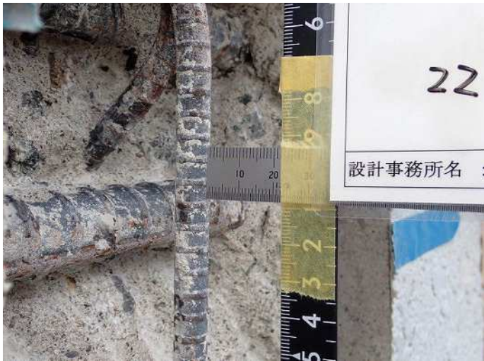
梁2 鉄筋かぶり厚さb 写真番号41詳細 写真番号 42
