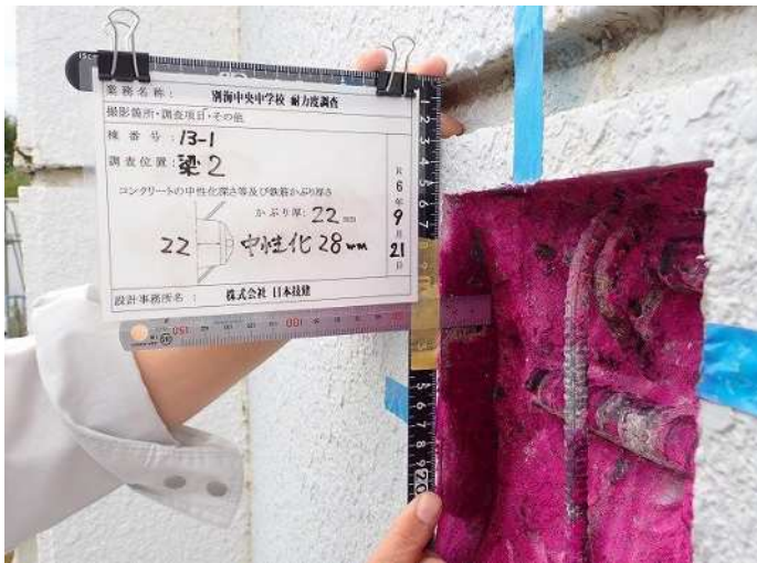
梁2 コンクリート中性化深さa 写真番号43詳細(1) 写真番号 44
