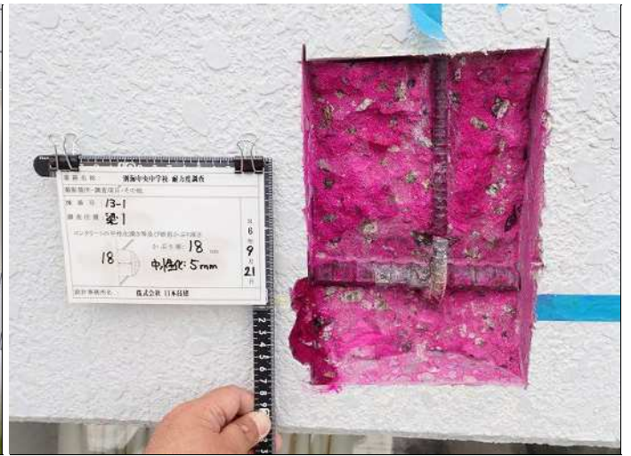
梁1 コンクリート中性化深さa 中性化深さ:0.5cm 写真番号 32
