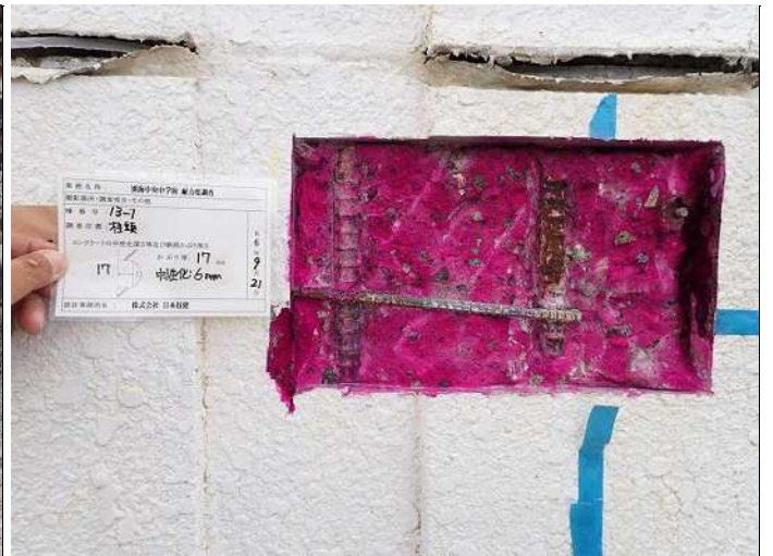
柱頭・柱1 コンクリート中性化深さa 中性化深さ:0.6cm 写真番号 10
