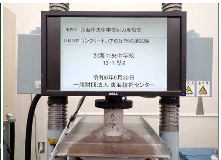
壁2 コンクリート圧縮強度k コンクリート圧縮強度試験状況 写真番号 12
