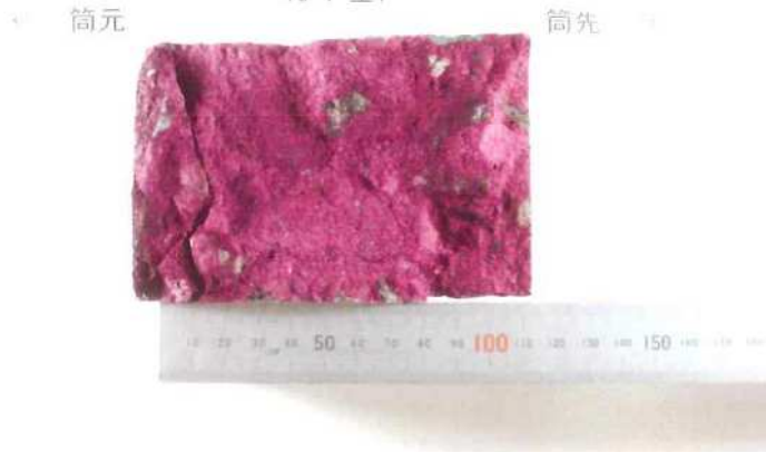
コンクリートの中性化深さ測定(フェノールフタレイン法) 別海中央中学校耐力度調査 別海中央中学校 13-1 壁1
