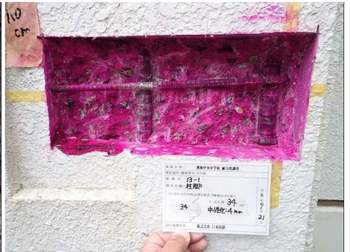
柱脚・柱2 コンクリート中性化深さa 中性化深さ:0.4cm 写真番号 21
