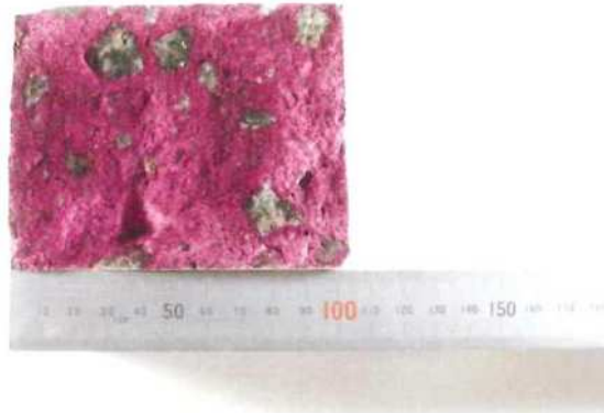
コンクリートの中性化深さ測定(フェノールフタレイン法) 別海中央中学校耐力度調査 別海中央中学校 13-2 壁2
