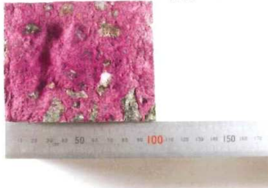
コンクリートの中性化深さ測定(フェノールフタレイン法) 別海中央中学校耐力度調査 別海中央中学校 13-2 壁3
