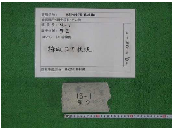
壁2 コンクリート圧縮強度k 採取コア状況 写真番号 11
