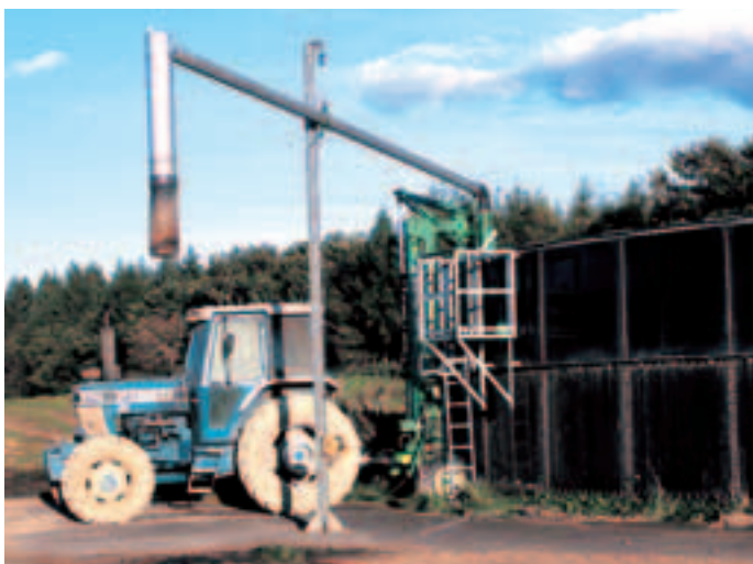
かんがい排水事業・肥培施設から液肥を汲み上げる機械
