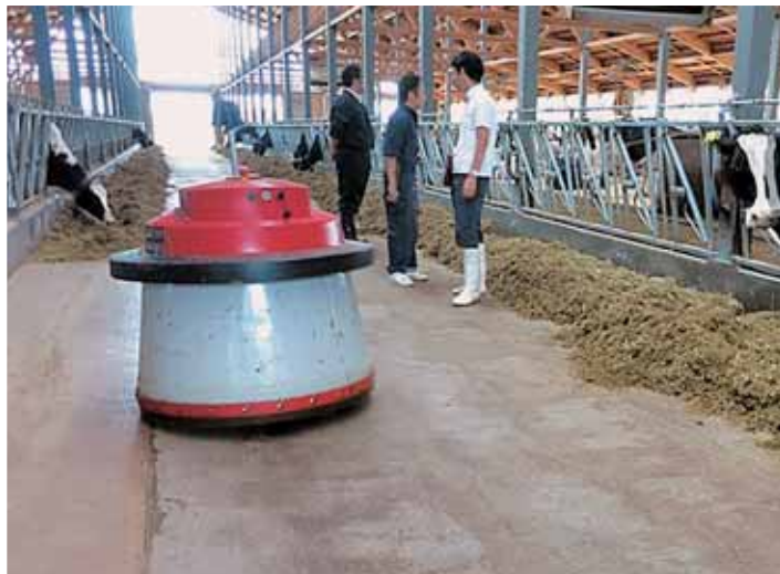
オークリファームの牛舎で使用されているエサ寄せロボット
