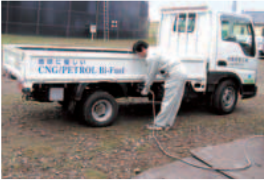
バイオガス燃料車の試運転でガスの充填をする
