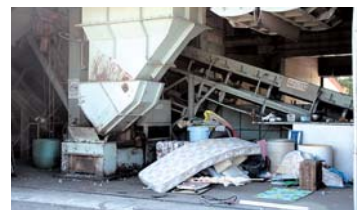
現在最終処分場で使用されている破さい機
