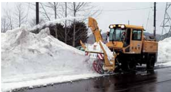
町道除雪中のロータリー除雪車
